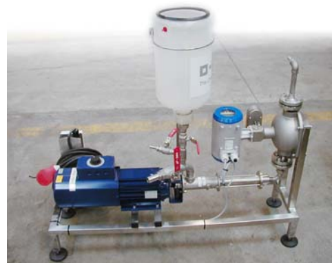
BASF Dosierstation mit OPTIMASS
