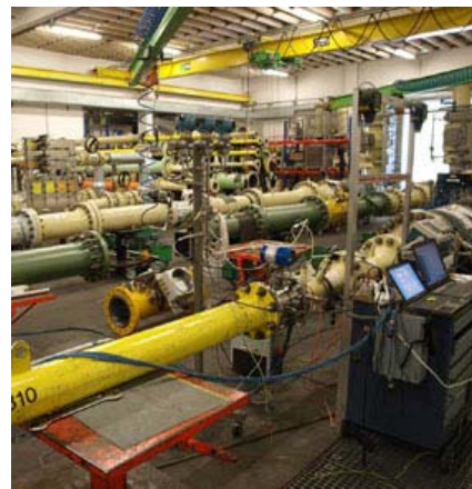
Bild 1: OPTISWIRL 4070 C auf dem pigsar-Prüfstand
